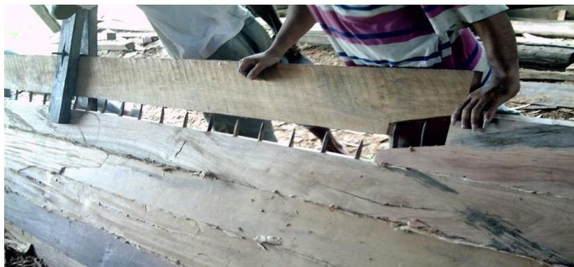
Gambar 4. Perakitan dan Penyambungan lambung kapal
