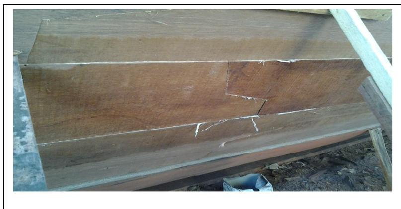
Gambar 5. Sambungan Lambung Kapal
