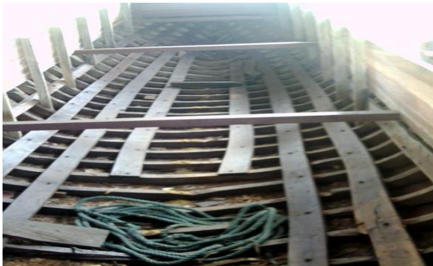
Gambar 7. Pemasangan galar balok dan galar kim pada gading kapal
