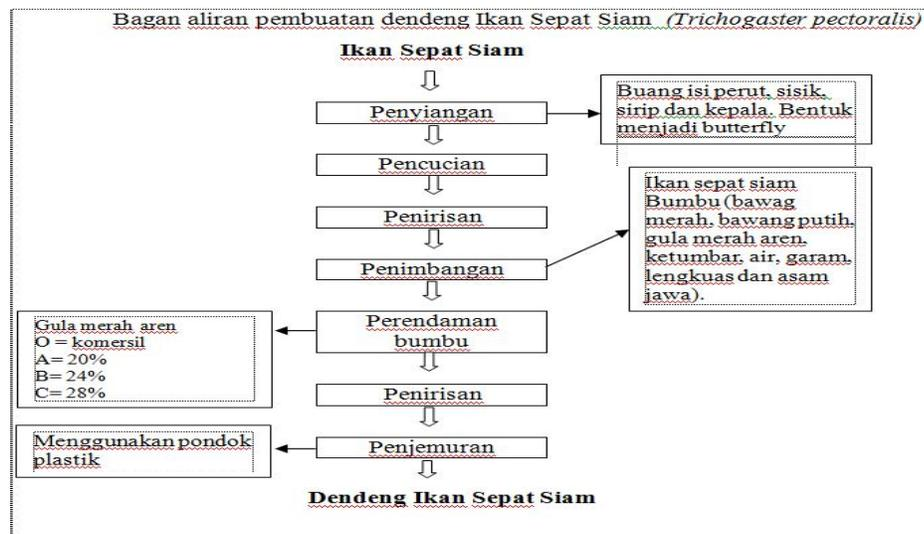
Gambar 1. Diagram Alir Pembuatan Dendeng Ikan Sepat Siam
